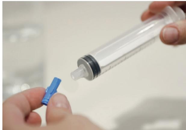
**Étape 6.2** Introduire l'adaptateur bleu pour seringue à l'extrémité de la seringue pour les raccorder.
