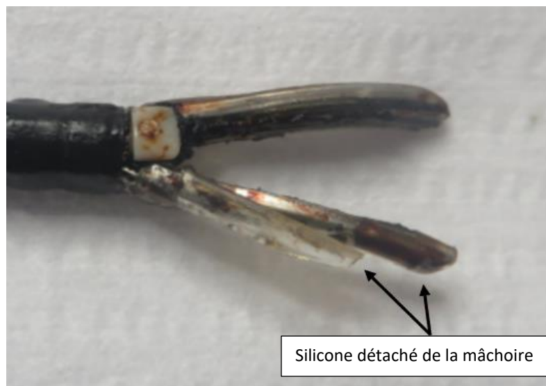
Figure 6 : Exemple de dispositif présentant un décollement du silicone.
