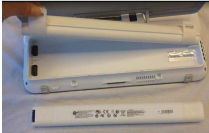
Figure 3-7. Retrait de la seconde batterie
