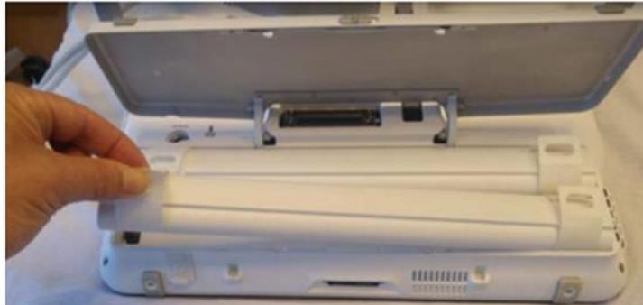
Figure 3-6. Remplacement d'une batterie
