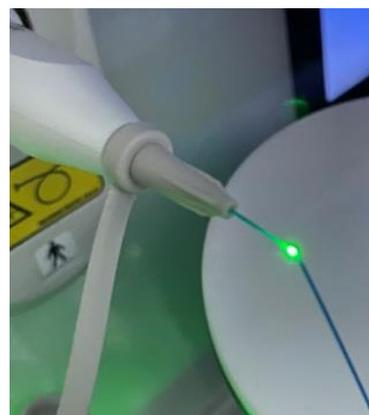
Image 6 : fibre endommagée sur la longueur
