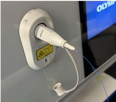
Image 3 : fibre non endommagée
