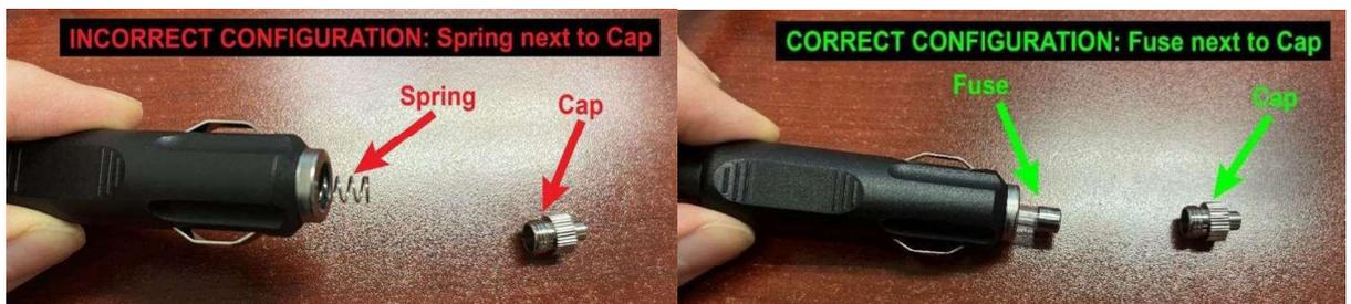
**Figure 3** : Inspection de l'adaptateur du cordon du chargeur de voiture pour vérifier la position du ressort ou du fusible.
