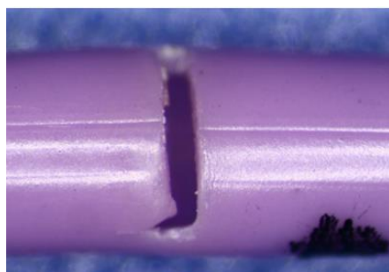
Image 1 : Exemple de fissure transversale/circonférentielle dans la tubulure du cathéter
