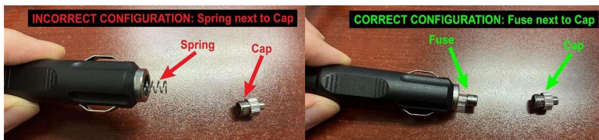
Figure 3 : Inspection de l'adaptateur du cordon du chargeur de voiture pour vérifier la position du ressort ou du fusible.
