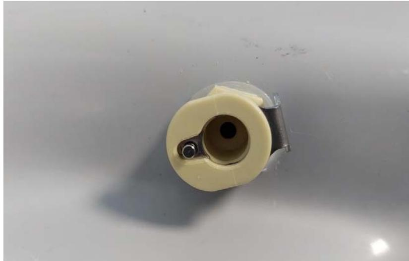
Figure 1 : Connecteur du test d'étanchéité dans la cuve
