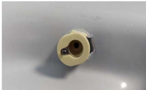
Figure 1 : Connecteur du test d'étanchéité
