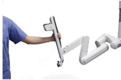
**Figure 2 :** Illustration qui montre comment tenir l'USM correctement pendant un positionnement manuel
