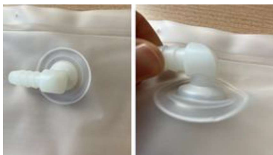
Figure 1 : Défaut de soudure du connecteur.
