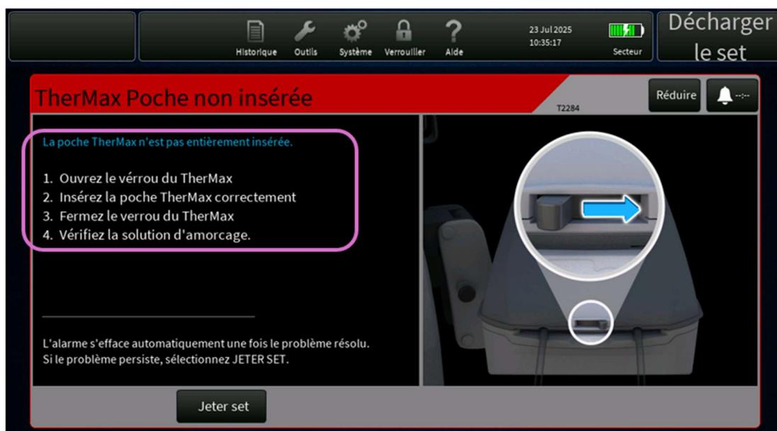
L'écran d'alarme guide l'utilisateur dans la résolution du problème de détection de la poche TherMax et fournit l'option « Jeter le set » si le problème n'est pas résolu.
