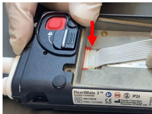
Figure 1 : Connexion du câble ruban de la pile de secours
