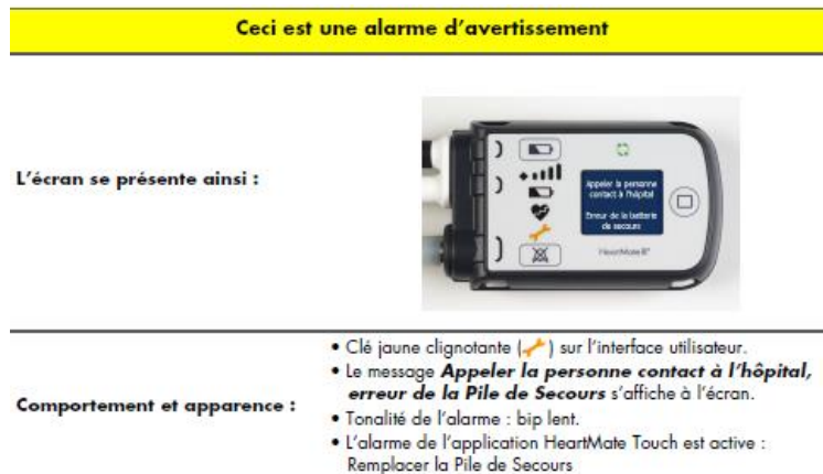
Figure 2 : Alarme de défaut de la pile de secours, pages 7-25, mode d'emploi du LVAS HeartMate 3™ destiné au clinicien
