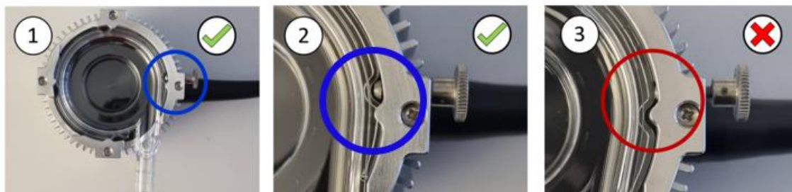
Figure 1- Illustration d'un ajustement correct et incorrect de la pompe
