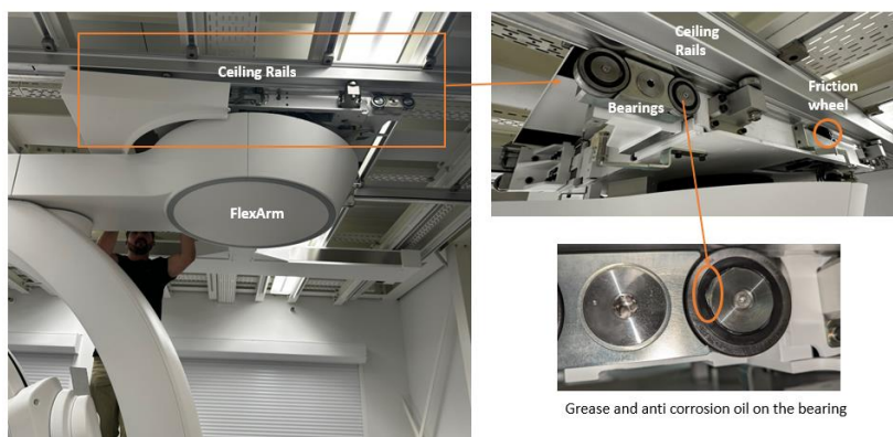
Figure 2 : Aperçu des éléments de statif FlexArm et identification du problème
