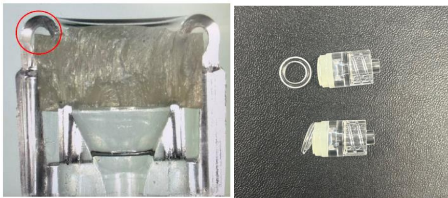
Figure 1 - Photo de la coupe de l'OBTMY02 (à gauche) et de bouchons obturateurs défectueux (à droite)
