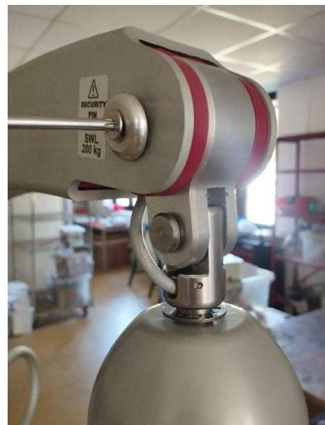
5.3 Réaliser un test de fonctionnement de la suspension électrique basculante en la tournant à 360° plusieurs fois tout en activant l'inclinaison de la suspension. Vérifier l'absence de bruits anormaux et la fluidité de la suspension, et le fonctionnement pendant la rotation.
