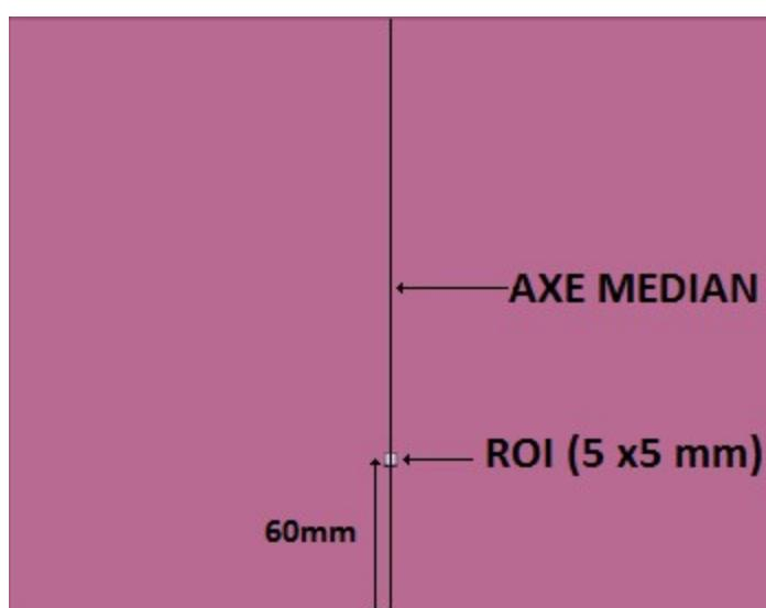
Par ailleurs, le critère relatif aux mAs à appliquer est :  $ABS\left(\frac{mAs_{(i)} - mAs_{(ref)}}{mAs_{(ref)}}\right) \leq 10\%$  et le critère relatif au SNR à appliquer est :  $ABS\left(\frac{SNR_{(i)} - SNR_{(ref)}}{SNR_{(ref)}}\right) \leq 10\%$
