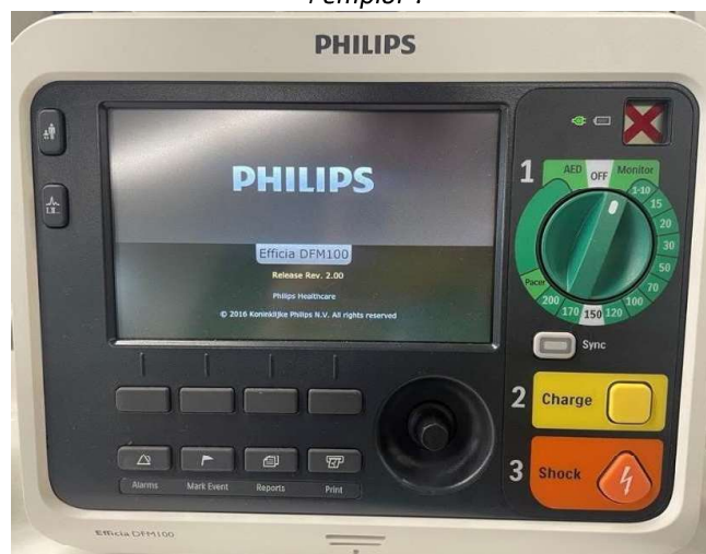
Figure 1 : exemple d'écran d'accueil du DFM100 avec une "X" rouge fixe dans l'indicateur d'état "prêt à l'emploi".
