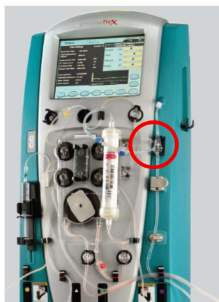
Figure 1 : Localisation du support de la chambre de dégazage
