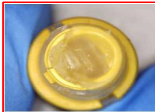
Figure 2 : Déchirure du joint en silicone
