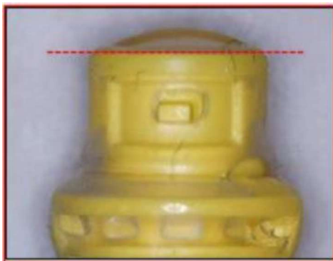
Figure 1 : Bombement du joint en silicone
