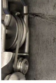
Figure C: Grossissement au facteur 20 d'un câble rompu sur un instrument da Vinci Xi.
