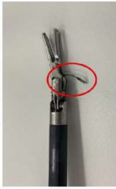
Figure H : Câble rompu
