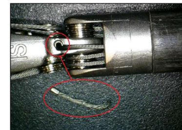
Figure C : Exemple d'un fragment de câble d'inclinaison.
