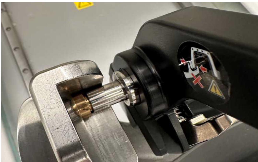
Figure 3. Adaptateur correctement ancré et aligné.
