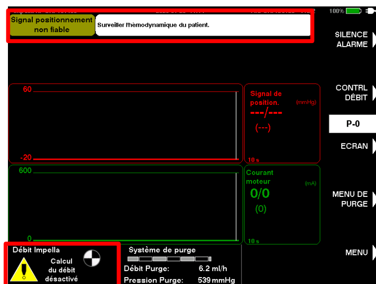
Figure 1 : Exemple d'écran AIC pendant l'alarme PSNR déclenchée par le capteur dP
