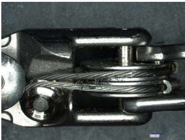
Figure D : Vue d'un câble de préhension effiloché sur un instrument da Vinci Si, grossie au facteur 20.
