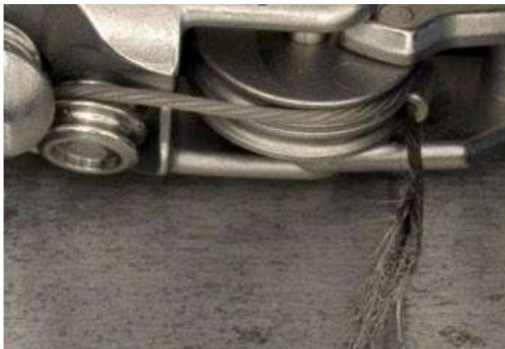
Figure C : Vue d'un câble de préhension rompu sur un instrument da Vinci Si, grossie au facteur 20.
