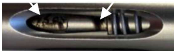
Figure 1: revêtement hétérogène du Pin Chuck
