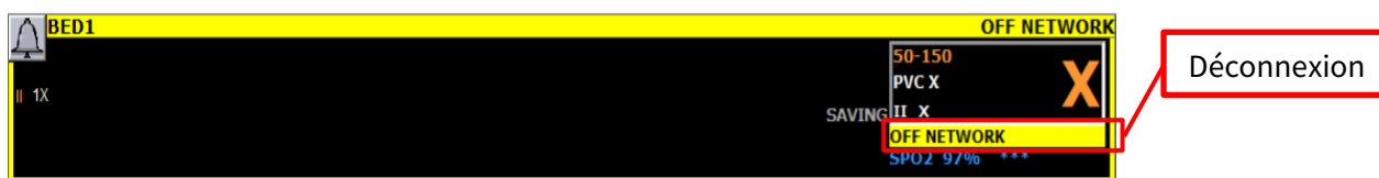
Figure 2. Illustration d'un scénario Déconnexion dans la fenêtre Multi-Viewer (Multifenêtre) de la station centrale avec indicateurs d'alarme sonores et visuels (icône de cloche et clignotement de barre de titre)
