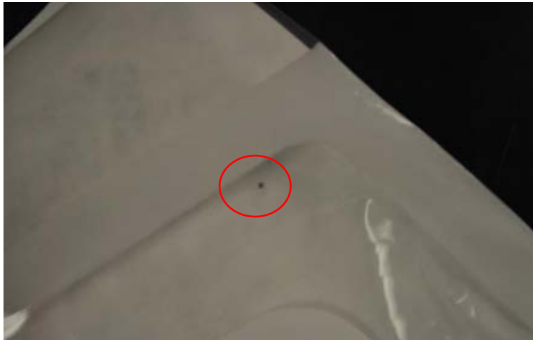
Figure 1 : Matériau étranger situé à l'intérieur de la pochette d'accessoires
