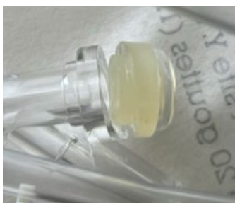
Site d'injection avec rupture
