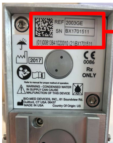
Figure 3 : Illustration de l'emplacement du numéro de série du mélangeur.
