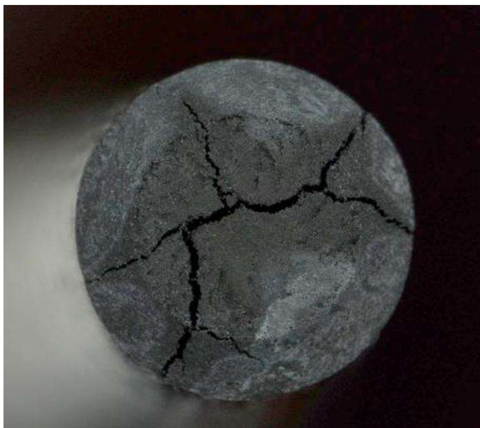
Figure 1 : Extrémité d'une barre à coulisse Hoffmann® II présentant des fissures
