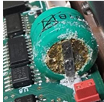
Figure 1 : Image de la batterie embarquée du BT1 corrodé
