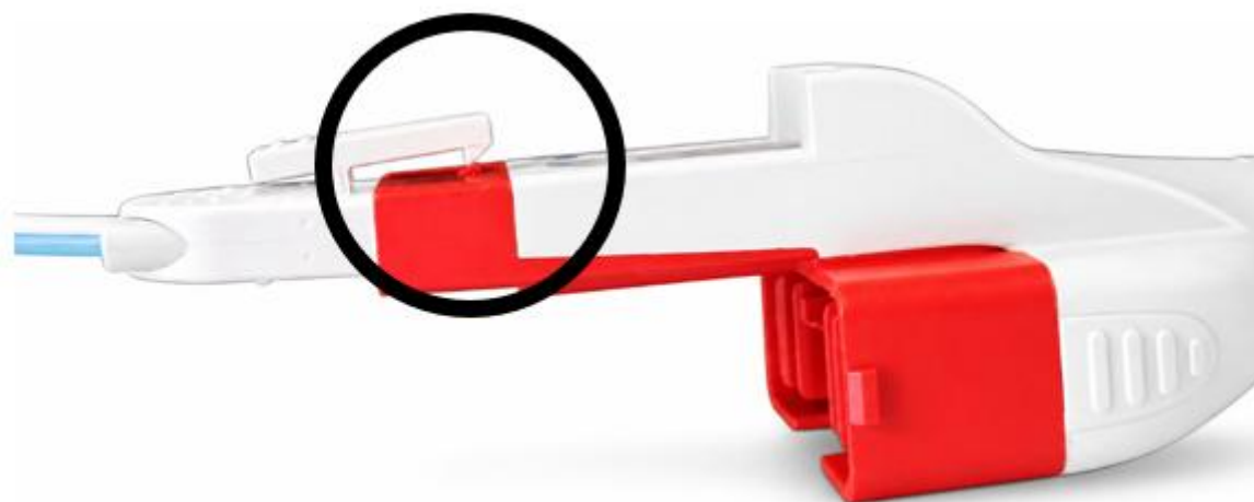
Figure 2. Le mécanisme de verrouillage ne s'engage pas complètement
