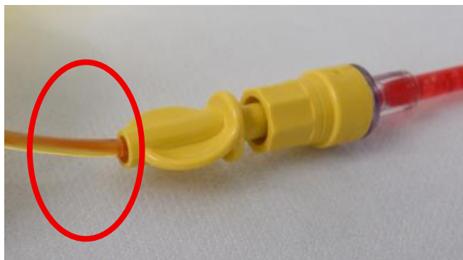
Figure 1 : Emplacement de la fuite
