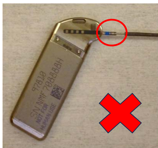
Figure 2b – Sonde et NSI incompatibles
