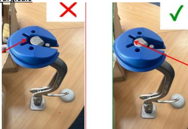
Image 2 : Platine mal assemblée (à gauche) par rapport à une platine correctement assemblée (à droite).
