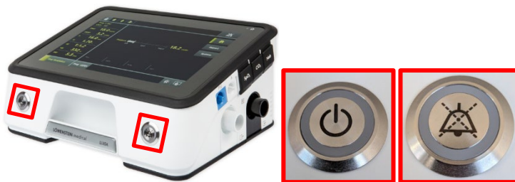
Illustration 1: appuyez à la fois sur le bouton Power et le bouton d'acquiescement des alarmes pendant environ 10 secondes pour provoquer une remise à zéro de l'appareil. Un écran noir s'affiche après environ 10 secondes et l'appareil redémarre.
