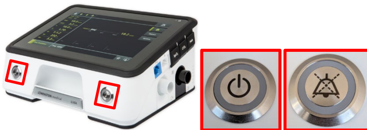
Illustration 1: appuyez à la fois sur le bouton Power et le bouton d'acquiescement des alarmes pendant env. 10 secondes pour provoquer une remise à zéro de l'appareil. Un écran noir s'affiche après env. 10 secondes et l'appareil redémarre.
